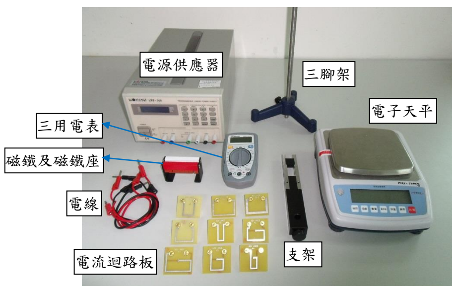
圖 7(b) 實驗二 勞倫茲力實驗之儀器
